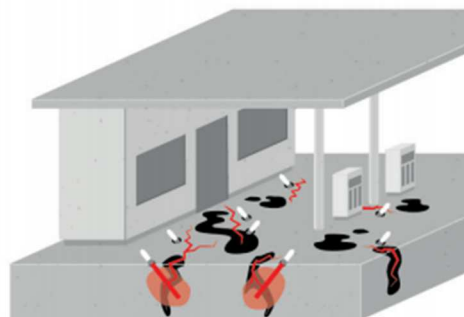
Усунення тріщин, забруднених маслом / жиром
